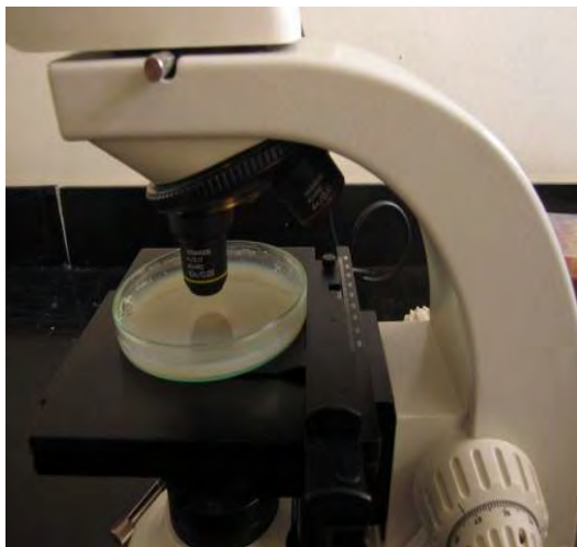
Figura 22. Microscopio acondicionado con un objetivo de 5x enfrente a uno de 10x
