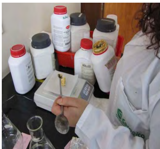
Figura 8. Uso de papel de celofán para pesaje de reactivos
