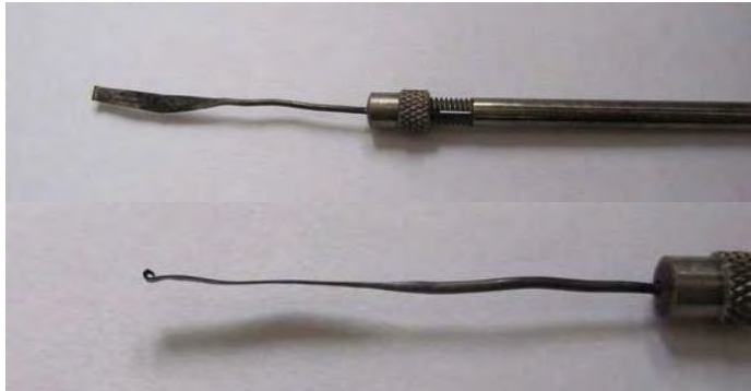
Figura 21. Asa modificada para el aislamiento de esporas
