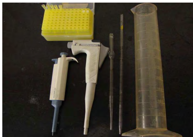
Figura 10. Toma de muestras para medir o para pesar reactivos líquidos
