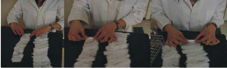
Figura 12. Procedimiento para hacer un tapón de algodón
