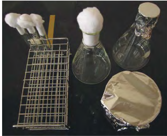
Figura 1. Material de vidrio cubierto con papel de aluminio
