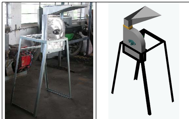
Figura 11. Molino de martillos CORPOICA para obtención de harina de arracacha.
