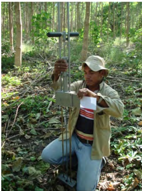
Figura 1. Medición de la resistencia mecánica del suelo
