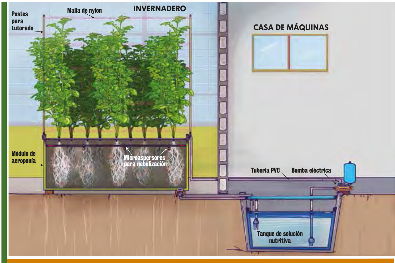
Esquema simplificado de un sistema de aeroponía en papa.
