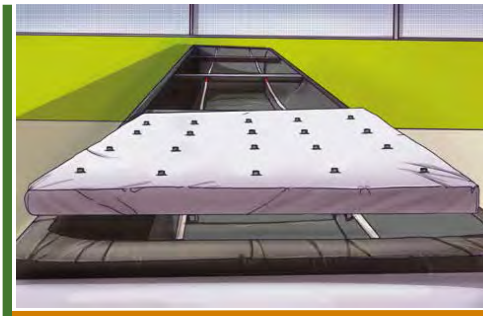
Tapa del módulo de aeroponía con orificios recubiertos por manguera donde se trasplantará las plántulas in vitro de papa.
