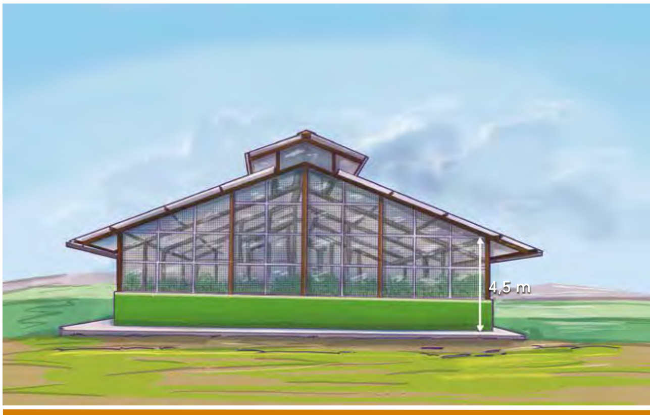
Altura recomendada de una casa de malla para aeroponía.
