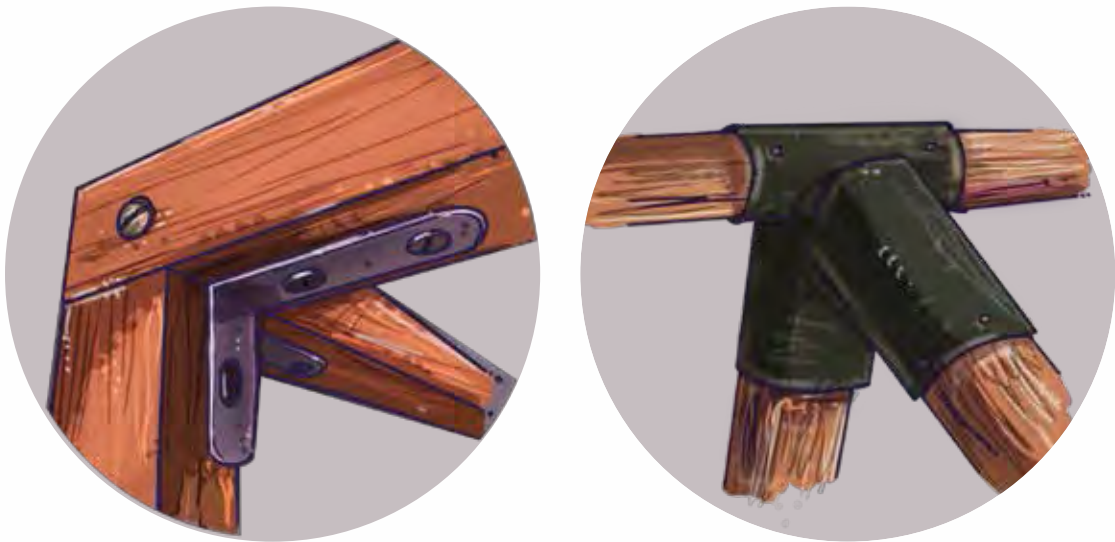
Ángulos metálicos para unión de vigas.
