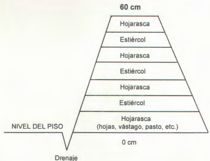
Figura 2. Secuencia del orden de las capas de los materiales
