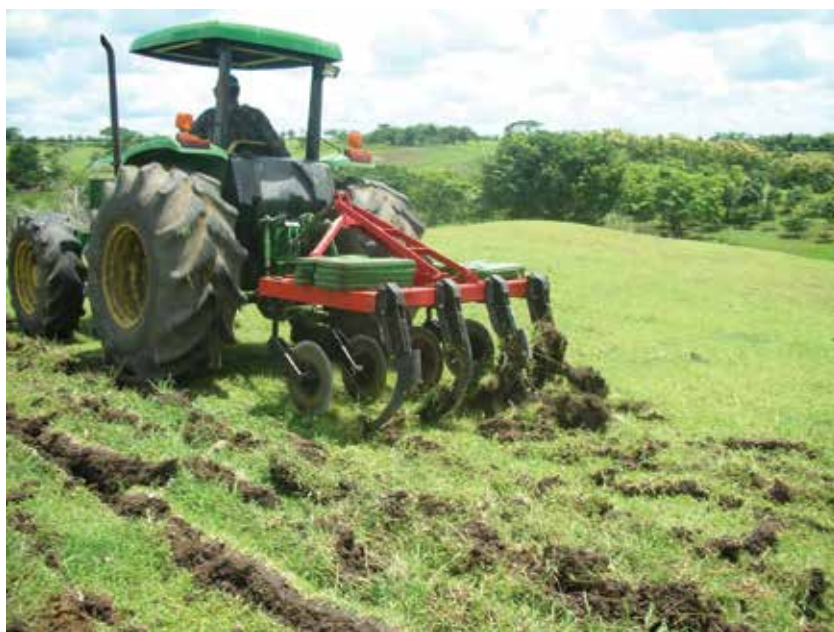
Figura 33. Paso de cincelos rígidos en la recuperación de una pradera existente.
