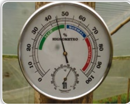
Figura 4.10. Diferentes termómetros y termohigrógrafos para tomar temperaturas y humedades máximas y mínimas al interior del invernadero
