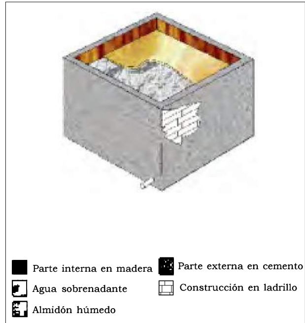
Figura 26-16. Tanque de fermentación del almidón agrio de yuca.
