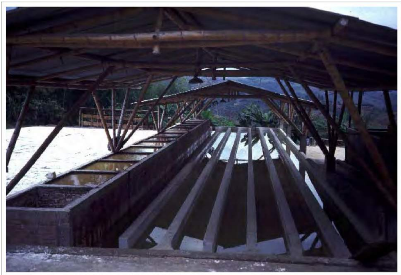
Figura 26-15. Sistema de siete canales para la sedimentación del almidón a partir de la lechada de yuca.
