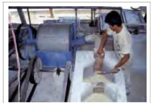
Foto 26A-10. Colado de la masa rallada (ver S. T. en Foto 26A-3).
