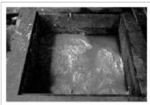
Foto 26A-12. Fermentación del almidón húmedo en tanques (ver S. T. en Foto 26A-5).
