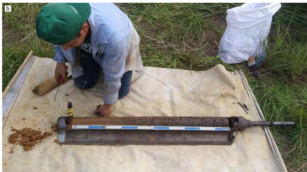
Figura 12. Muestreo en calle de cultivo para cuantificación de COS. a. Muestreo mediante barreno de núcleo de suelos; b. Muestra de un núcleo de suelo de un metro. Fotos: Diana Mateus
