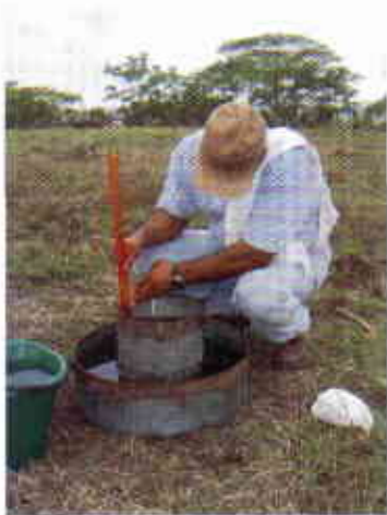
Foto 9. Evaluación de la velocidad de infiltración del agua y de la resistencia a la penetración. Finca Sabalito, municipio de Puerto Escondido (Córdoba)
