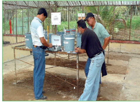
Actividad de registro de potencial hídrico del suelo
