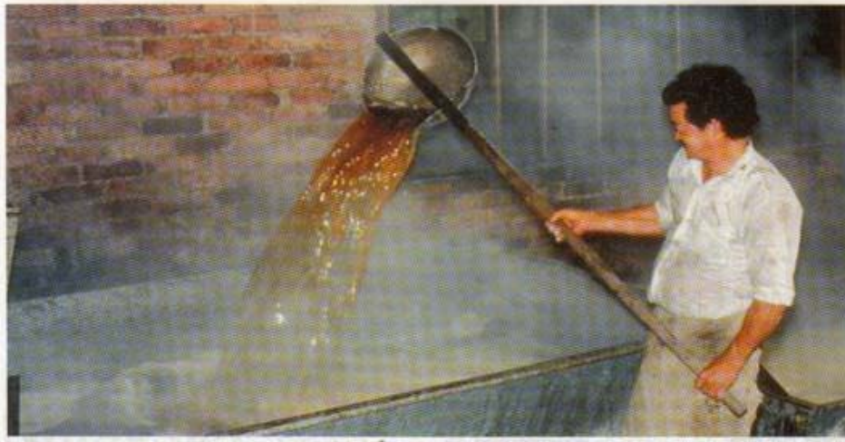
Figura 66 Punteo de la panela
