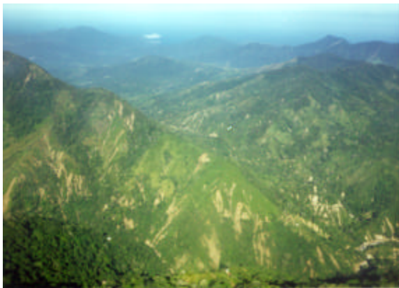
Efectos de la avenida torrencial y de los múltiples deslizamientos ocurridos en la vertiente noroccidental de la Sierra Nevada de Santa Marta, cuencas de los ríos Manzanares, Guachaca y Piedras. Obsérvese los deslizamientos, los escombros y el área de depositación de la creciente.
