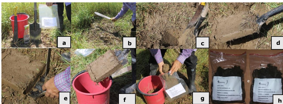
Figura 13. Procedimiento para la toma de muestras de suelo. a. Implementos necesarios; b. Limpieza de la superficie del suelo; c. Hoyo para la toma de muestras; d. Extracción de la muestra; e. Limpieza de la muestra; f. Depósito y mezcla de las diferentes submuestras; g. Empaque de las muestras; h. Marcaje de las muestras y contramuestra para envío a laboratorio.
