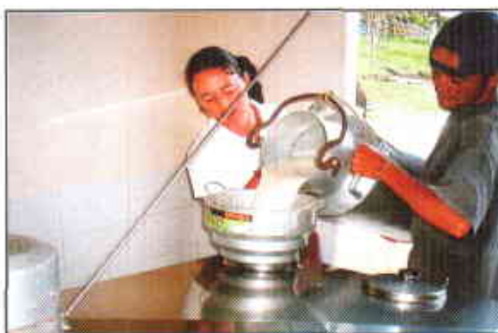
Vaciado de cantinas al tanque enfriador con embudo y filtro
