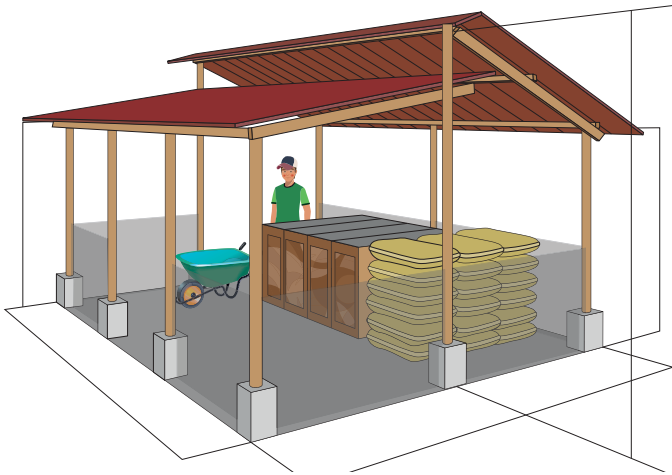
Figura 2. Diseño de compostera con techo 1.
