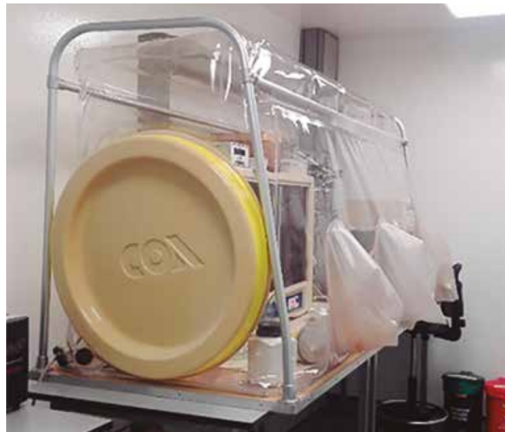
Figura 36. Cámara anaeróbica usada en la CMINA.
