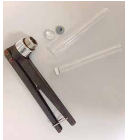
Figura 40. Tubo tipo Blach con tapón de butilo, agrafe y agrafador/desagrafador.
