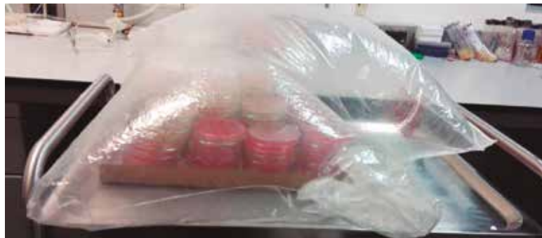
Figura 38. Cámara anaeróbica portátil.
