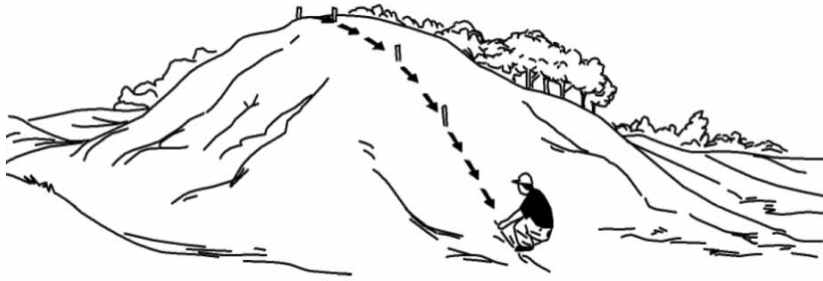
Figura 43. Trazo de la línea madre para la nivelación de un terreno. Tomado de FHIA, 2004.
