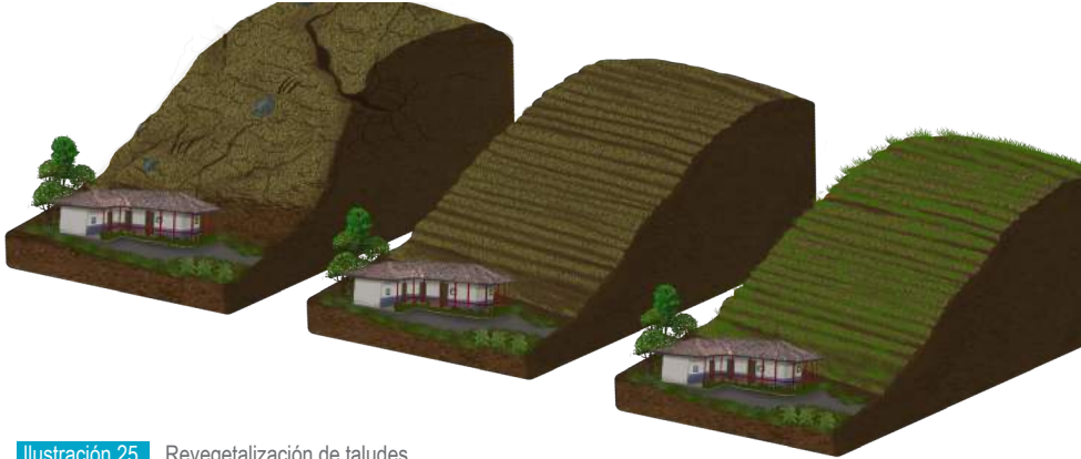
Ilustración 25. Revegetalización de taludes
