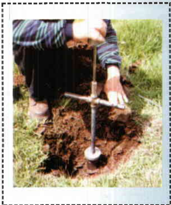
toma de muestra inalterada para determinación de retención de humedad y densidad aparente.
