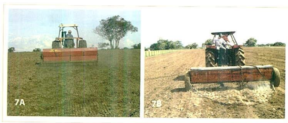
Figura 7. Siembra de los pastos con máquina en surcos (7A) y con encaladora (7B).
