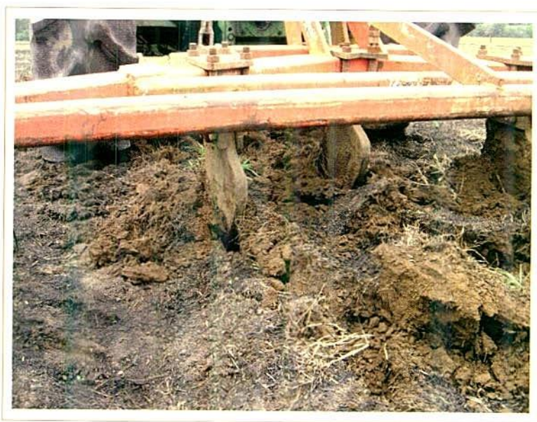
Figura 4. Labranza vertical con cincel rígido para el establecimiento de la asociación maíz-pastos.
