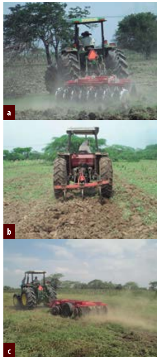
Figura 1. Diferentes pasos en la preparación del suelo. a. rama, b. cincel. c. pulidor
