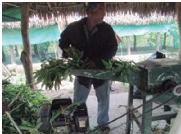
Figura 10. Picadora adaptada con motor de combustible
