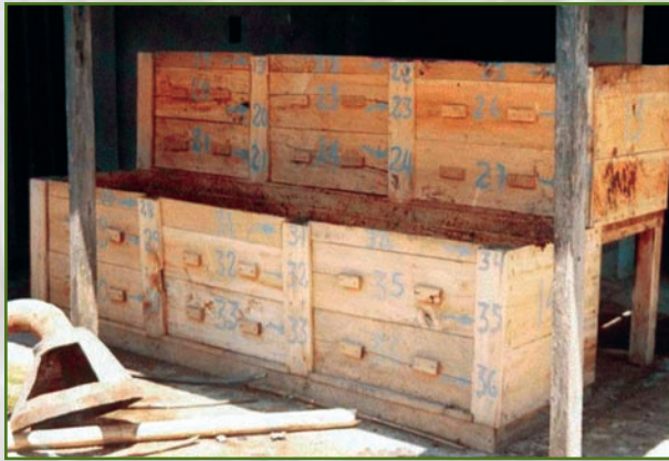
Fermentador tipo escalera de dos niveles
