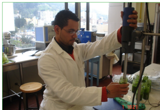
Homogenización de la muestra para determinación de sólidos solubles
