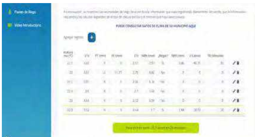
Figura 67. Registro de datos para determinar las necesidades de riego de acuerdo con el método de cálculo de ETO.
