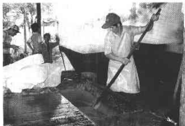
Foto 11. Proceso de batido y enfriamiento de las mieles previo al moldeo.
