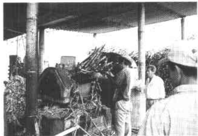
Foto 5. Trapiche panelero utilizado en la extracción del jugo de la caña
