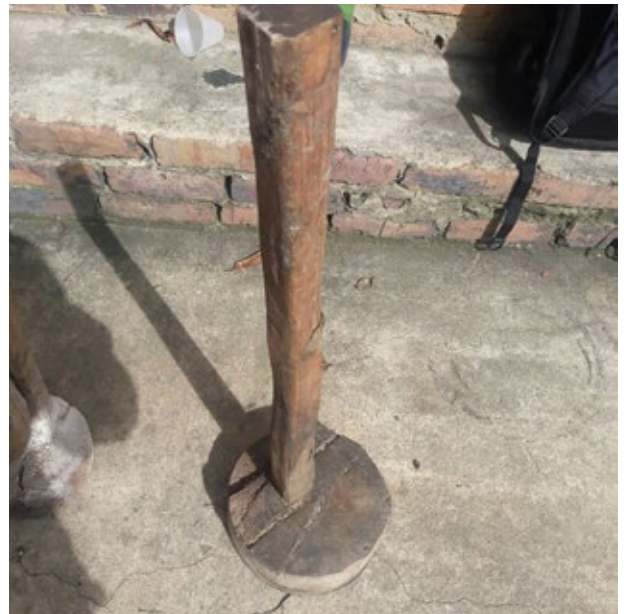
Compactador manual usado en Santa Rosa de Viterbo.
