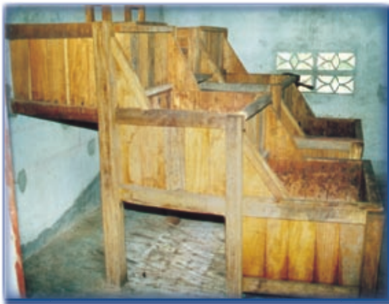
Cajones tipo escalera
