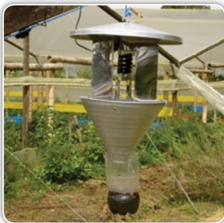
Figura 7.6. Trampa de luz para la captura de insectos
