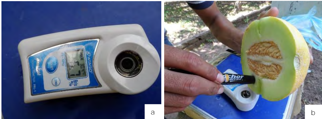
Figura 39. Metodología para la determinación de contenido de azúcar de melones. a. Refractómetro-equipos de medición de los grados Brix; b. Análisis de una muestra.
