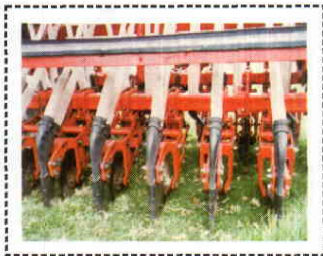
Figura 1.3. Sembradora de grano pequeño usado para renovación de praderas degradadas de Kikuyo.
