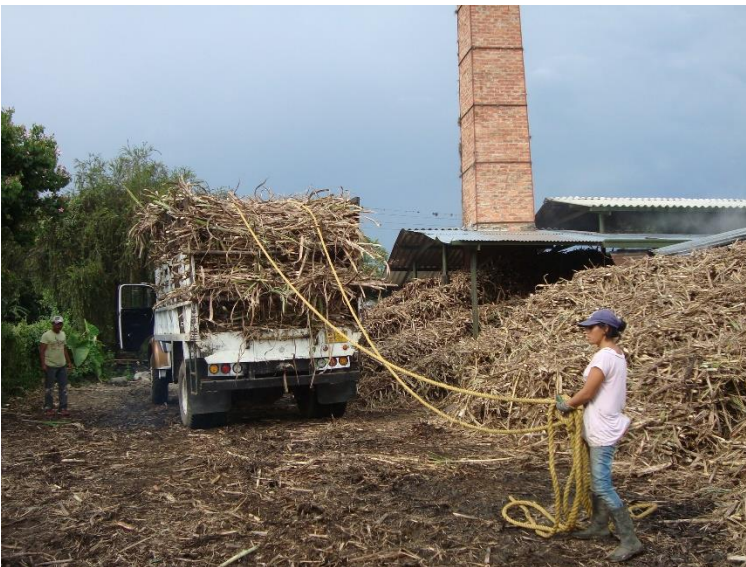
Figura 57. Camión descargándolo con manila.
