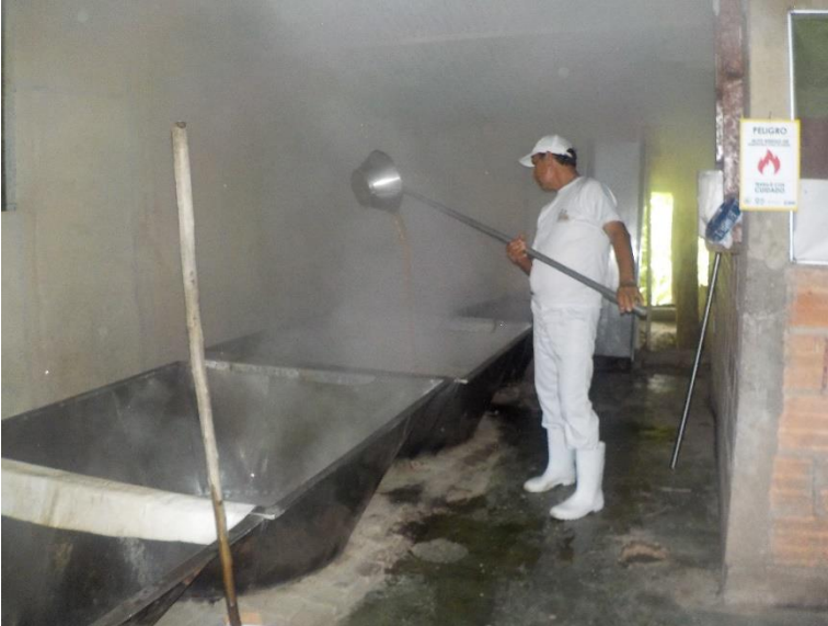
Figura 76. Batería de concentración de hornilla panelera.
