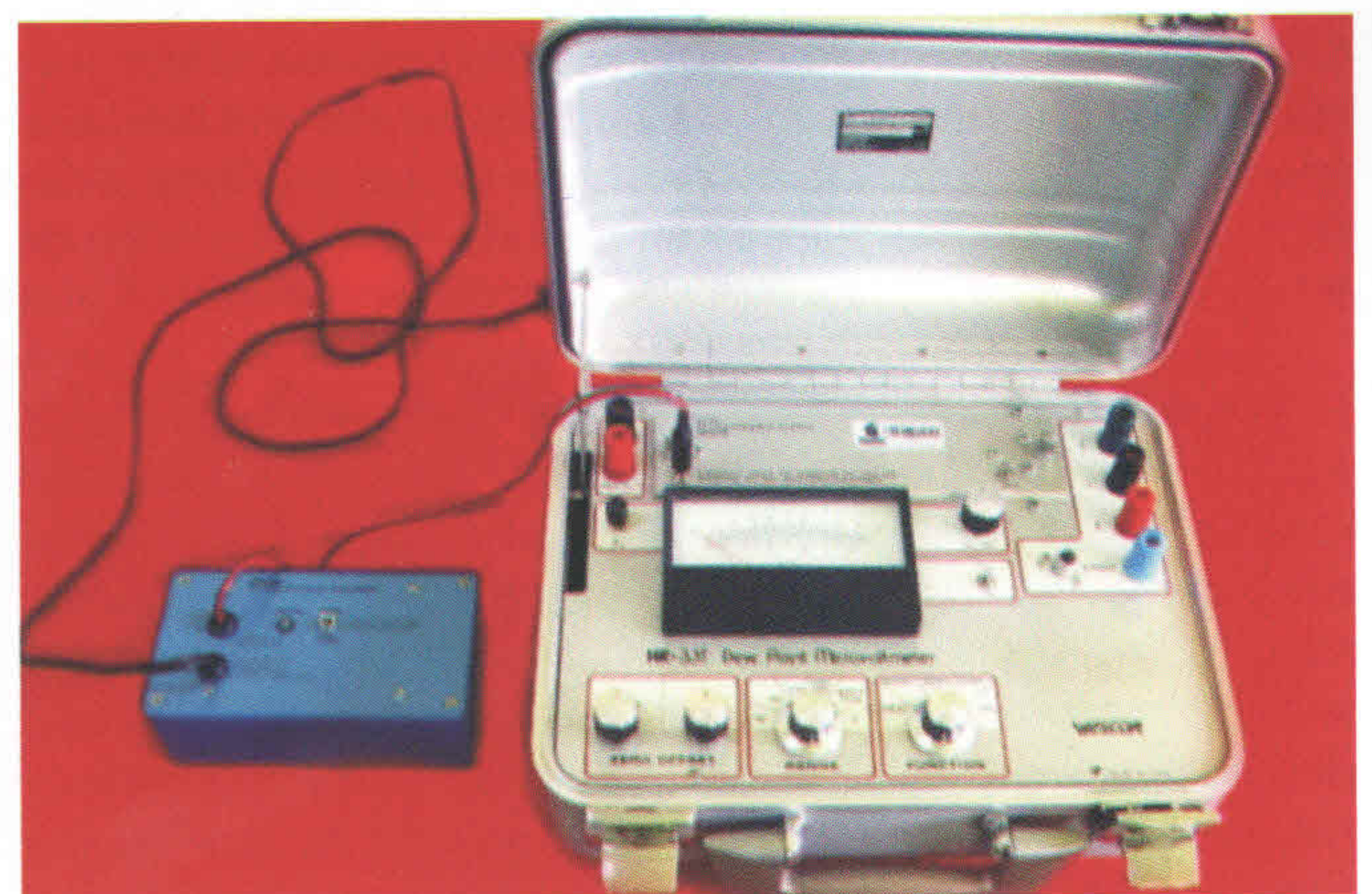
Figura 5. Microvoltímetro Wescor para determinar el potencial hídrico de la hoja
