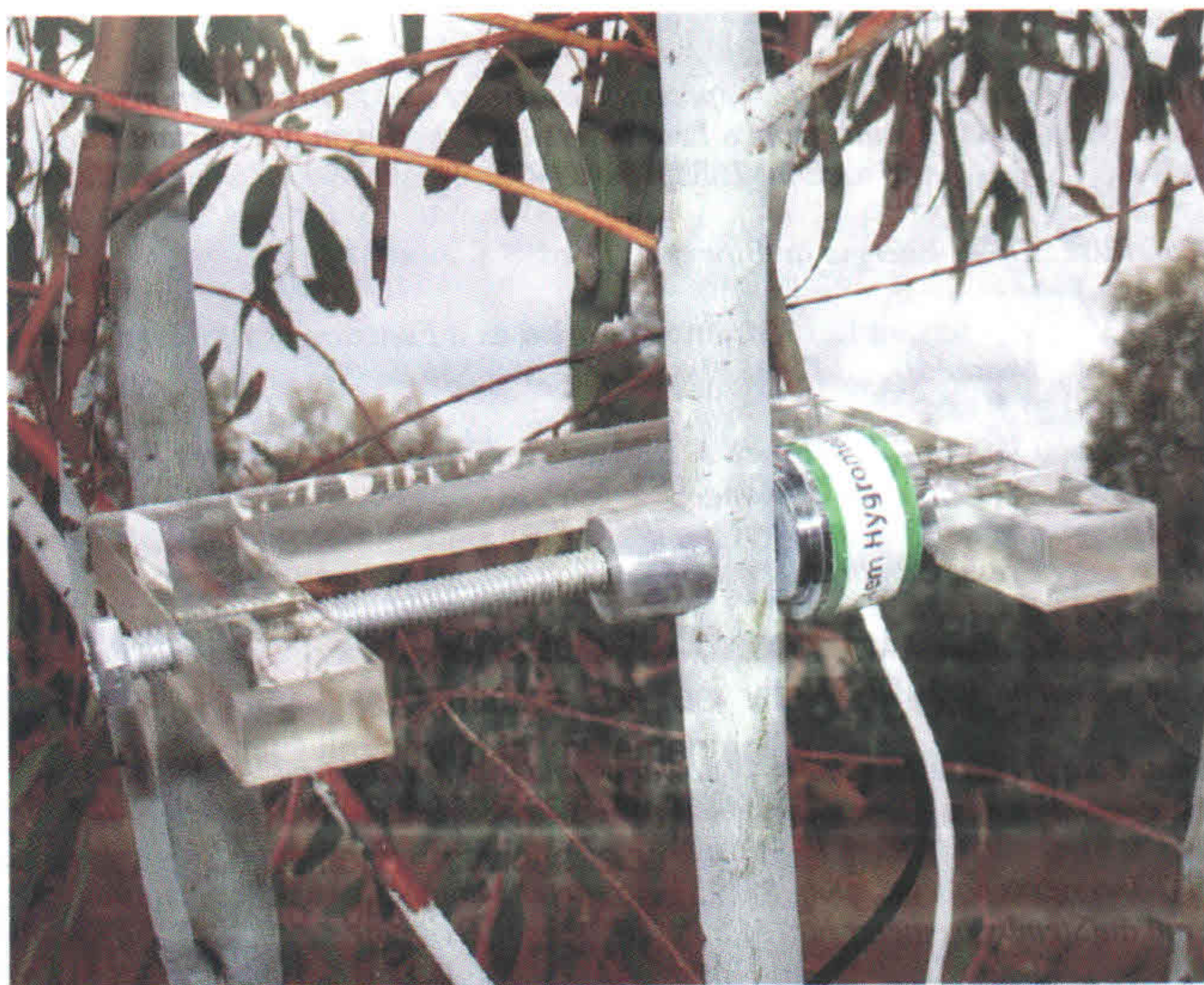
Figura 6. Higrómetro del tallo: permite medir el potencial hídrico.
