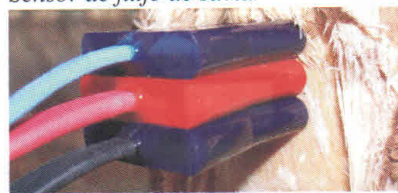
Figura 8. HRM (Heat Ratio Method). Sensor de flujo de savia
