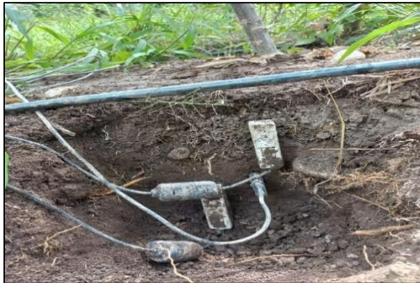
FIGURA 11. Sensores de humedad del suelo tipo capacitivo: medición precisa a 10 cm y 20 cm de profundidad
