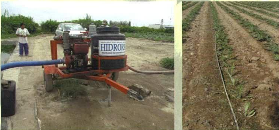
Figura 16. Izquierda: equipo de fertirriego portátil utilizado en cultivos de alcachofa en Perú. Derecha: ubicación de las líneas de goteo.
