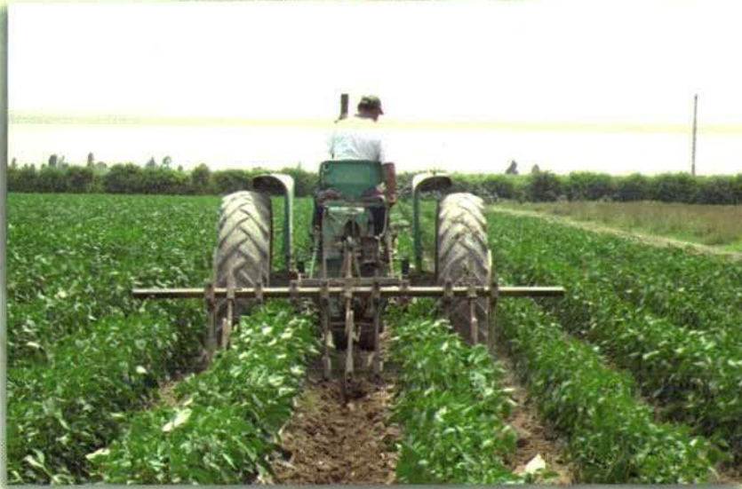
Figura 23. Cultivadora acoplada al tractor para control mecánico de malezas
