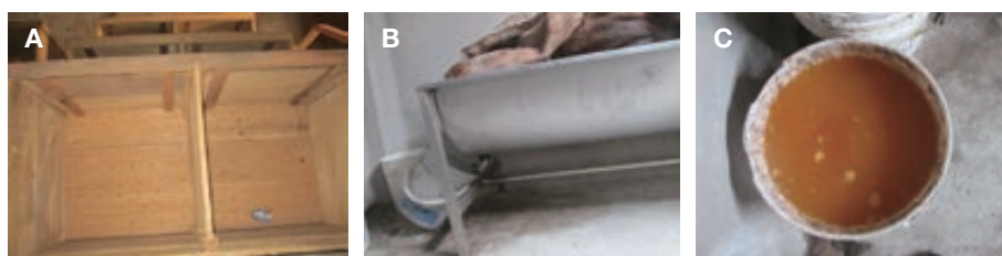
Figura 119. | Sistema de drenaje de lixiviados. a. Orificios en el fondo del fermentador; b. Recolección de lixiviado; c. Lixiviados
