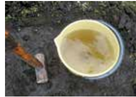
Agua en movimiento: suelo poco compactado
