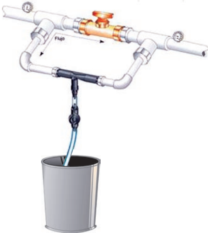
FIGURA 37. SISTEMA VENTURI INSTALADO DENTRO DE LA TUBERÍA DE DESCARGA DE UN SISTEMA DE RIEGO A PRESIÓN.
