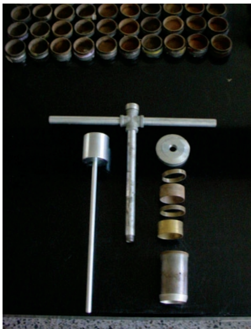
FIGURA 14. MUESTREADOR UHLAND PARA TOMA DE MUESTRAS EN LA DETERMINACIÓN DE LA DENSIDAD APARENTE. IZQUIERDA: DISPOSITIVO DESARMADO. DERECHA: DISPOSITIVO ARMADO (LUTHIN ET AL. , 1967).
