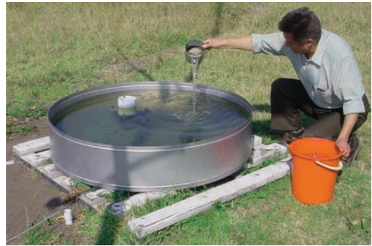
FIGURA 34. TANQUE EVAPORÍMETRO “TIPO A”. IZQUIERDA: DIMENSIONES ESQUEMÁTICAS. DERECHA: EL OBSERVADOR ESTÁ ADICIONANDO LOS MILÍMETROS EVAPORADOS EL DÍA ANTERIOR.
