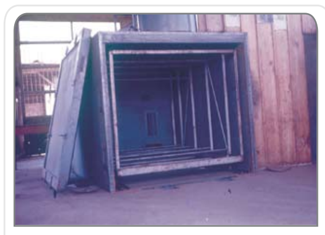
Figura 14. Equipo para tratamiento térmico de semilla
