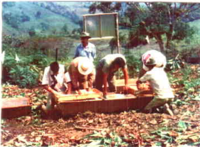
a. Tamizando el almidón en el lote de cosecha en una rallandería portátil
