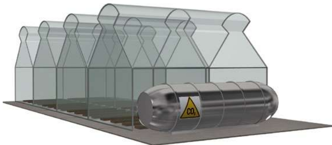
Figura 39. Sistema de inyección de \text{CO}_2 purificado.
