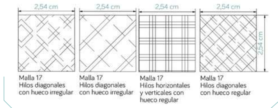
Figura 29. Diferentes tramados de malla usados en la fabricación de materiales comerciales.
