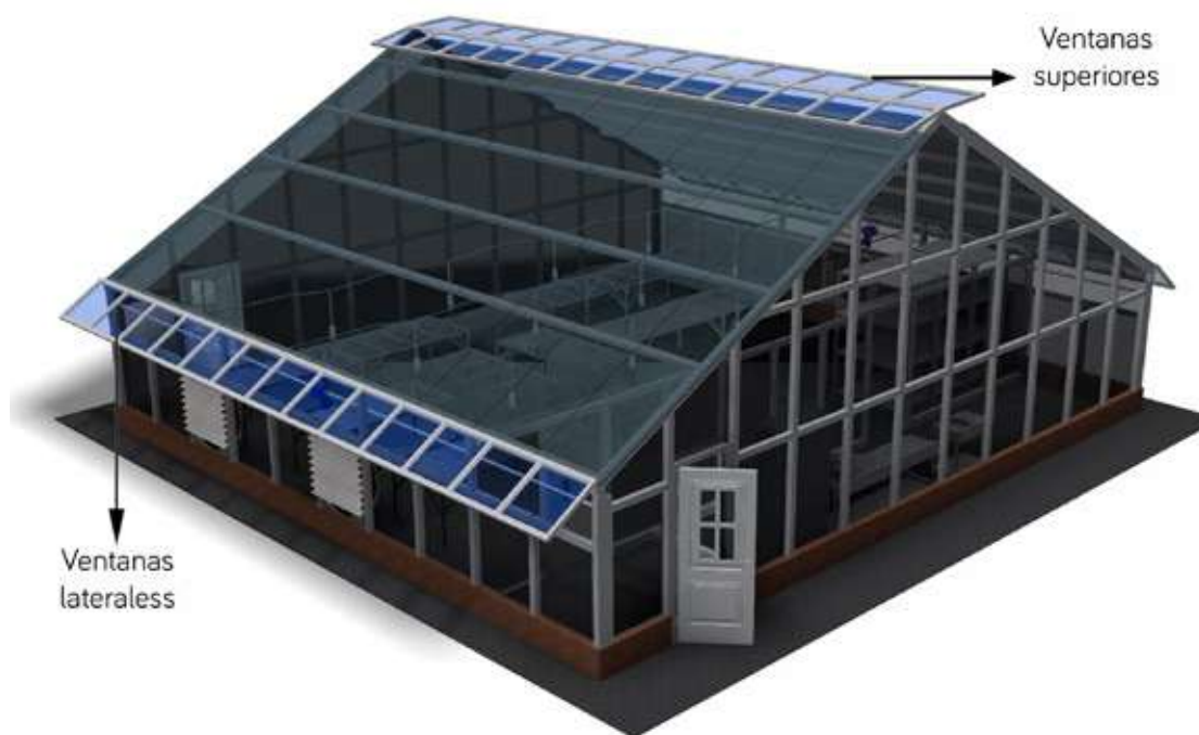
Figura 46. Invernadero cerrado con ventanas superiores y laterales para el control de flujo de aire.
