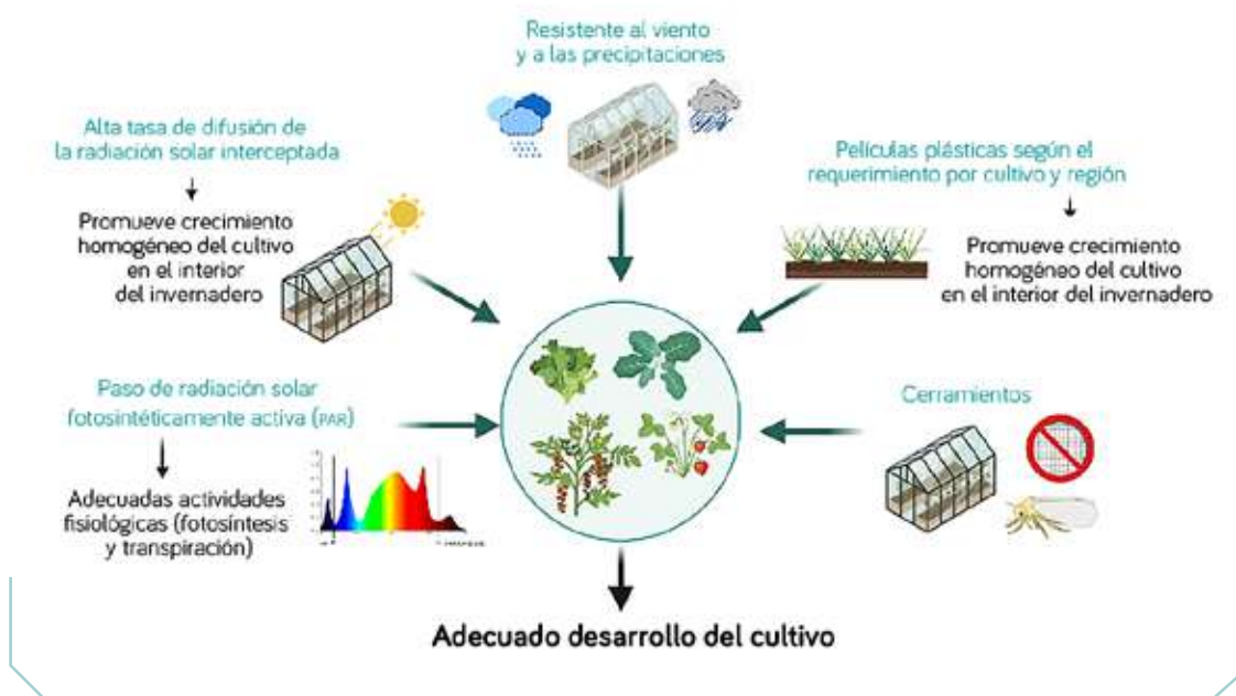
Figura 31. Factores claves para la elección de materiales de cubierta y cerramiento y para el adecuado desarrollo de un cultivo bajo invernadero.
