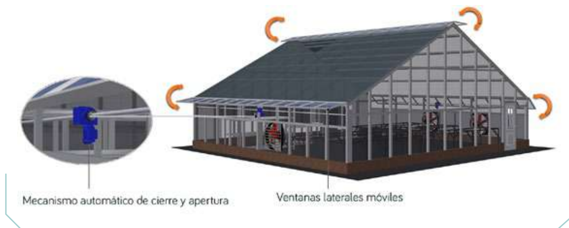
Figura 32. Áreas de ventilación de techo y laterales mecanizadas y automatizadas.
