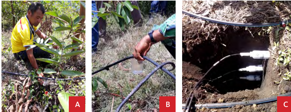
Figura 10. Monitoreo y verificación del funcionamiento del sistema de riego. A y B: Medición de cantidad de agua suministrada por goteros. C: Sensores para medición de humedad del suelo. Fotos A y B: Diana Lucía Correa. Foto C: Diana Dorado.
