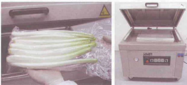
Figura 9.9. Cebolla empacada al vacío y equipo utilizado.
