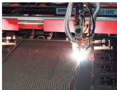
Figura 33. Placa de acero recubierta con soldadura.
