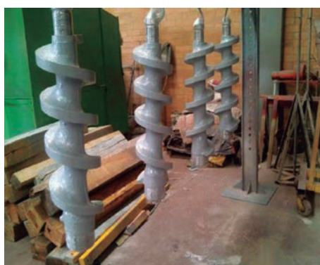
Figura 43. Secado y curado de la pintura polimérica.
