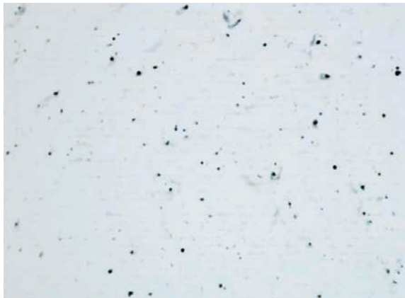
Figura 8. Inclusiones tipo ASTM D2 de la serie fina presentes en el acero fundido. Zoom: 100 X. Norma ASTM E45 Standard Test Methods for Determining the Inclusion Content of Steel .
