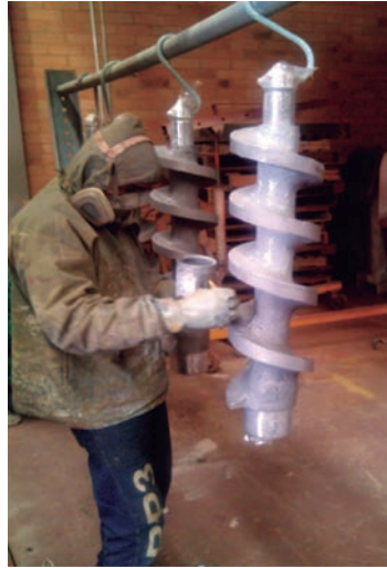
Figura 42. Aplicación pintura polimérica. (IMANTT, 2013).
