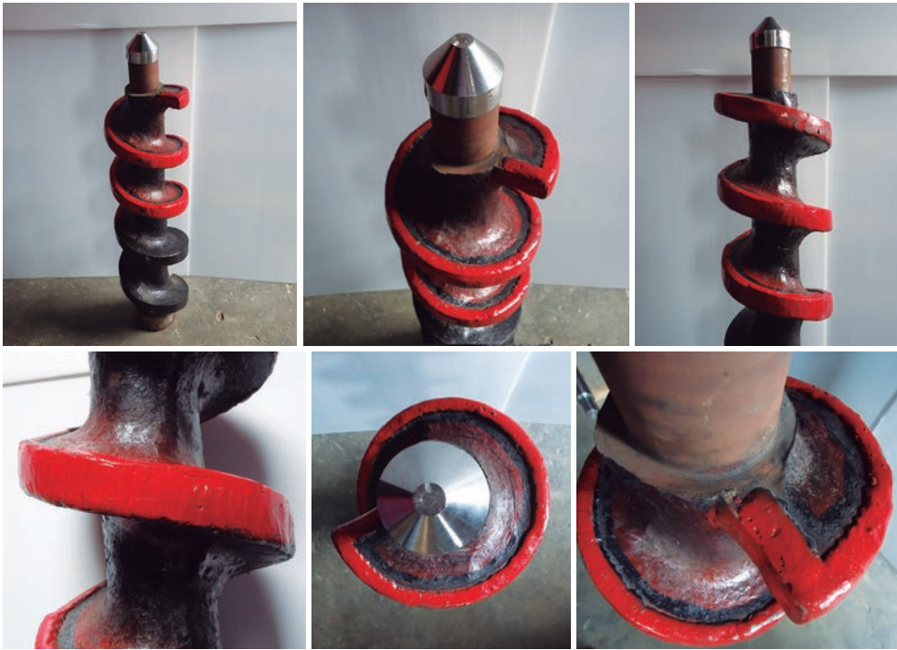
Figura 39. Acabado de los tornillos con recubrimientos por soldaduras.
