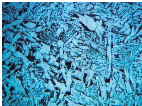
Figura 10. Microestructura en la zona del centro de la probeta. Ferrita Widmanstätten. Zoom 100X.
