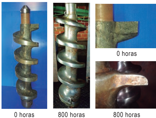
Figura 20. Apariencia del tornillo al final de la primera vida útil.
