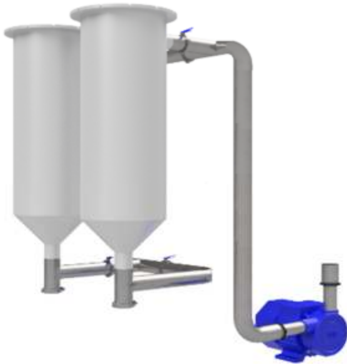
Figura 9. Sistema de filtración de jugos con mangas.
