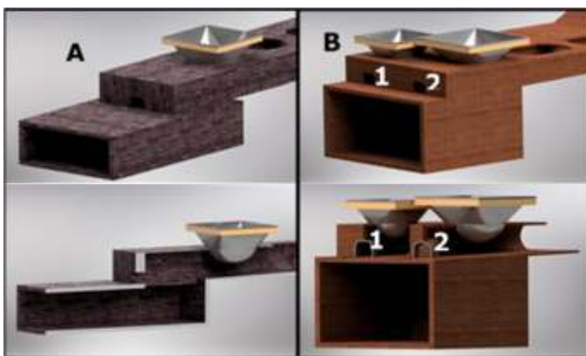
Figura 6 Cámara de combustión. a. Hornilla tradicional; b. Hornilla tipo Cundinamarca.
