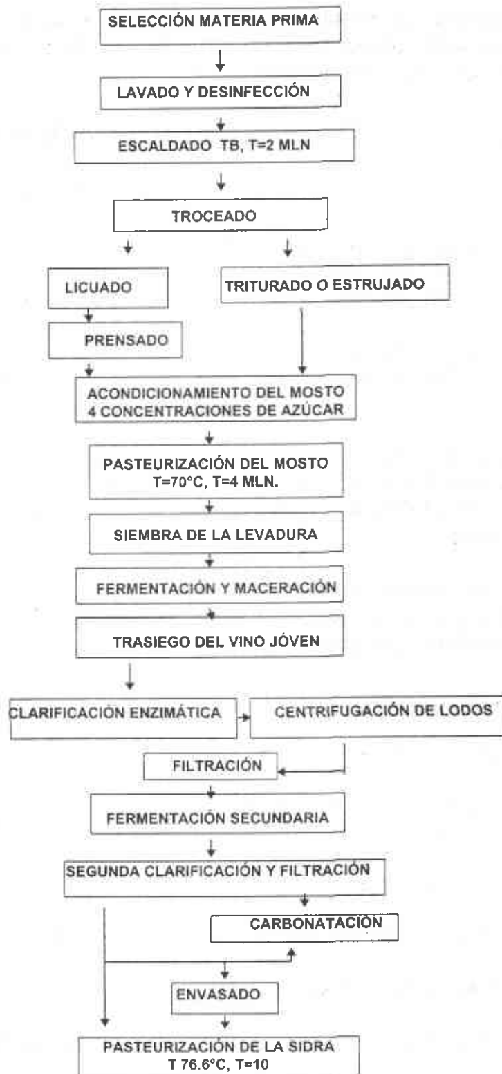
Figura 1. DIAGRAMA DE FLUJO DEL PROCESO DE OBTENCIÓN DE SIDRA
