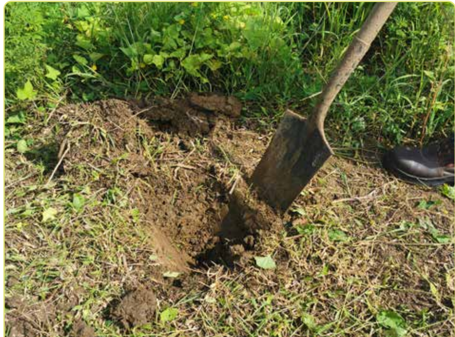
Figura 2. Herramienta para la toma de muestra (palín).
