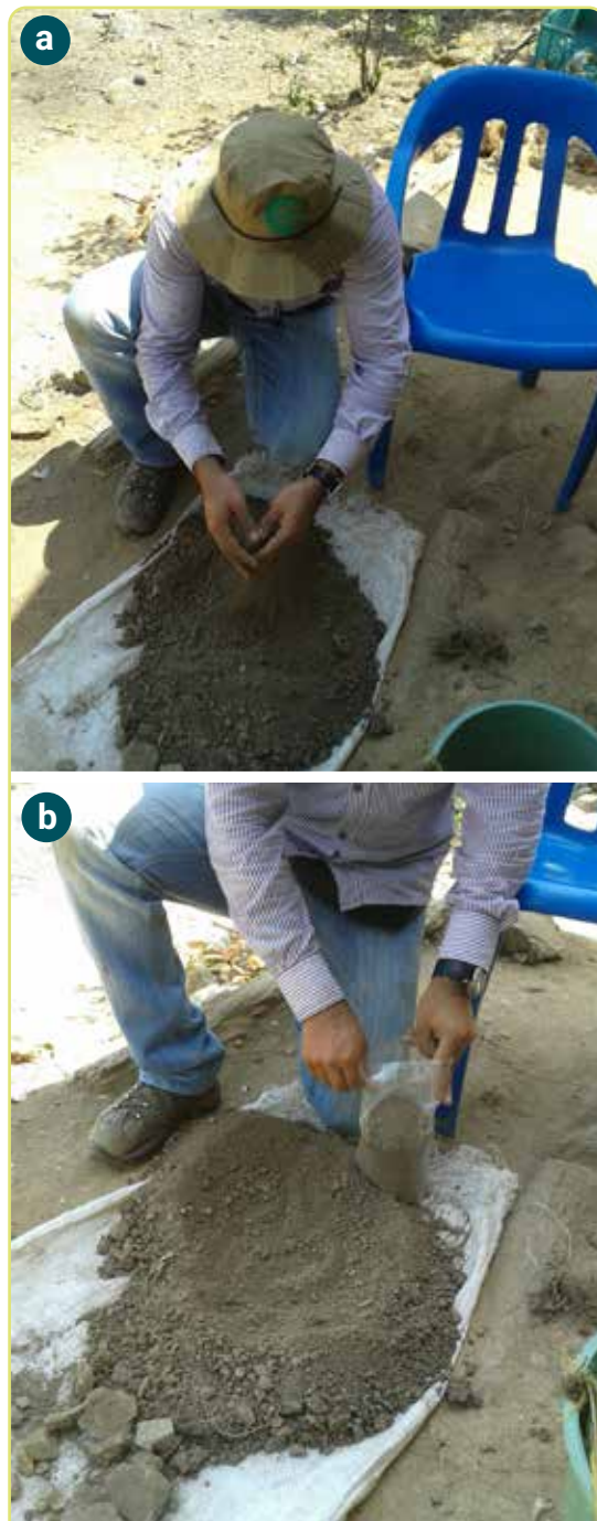
Figura 4. Homogenización de las submuestras de suelo. a. Mezcla de las submuestras; b. Se toma 1 kg de la mezcla y se envía al laboratorio.
