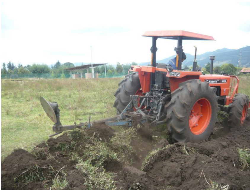
Figura 13. Preparación de suelo con arado de disco Fuente: Pedro David Porras Rodríguez
