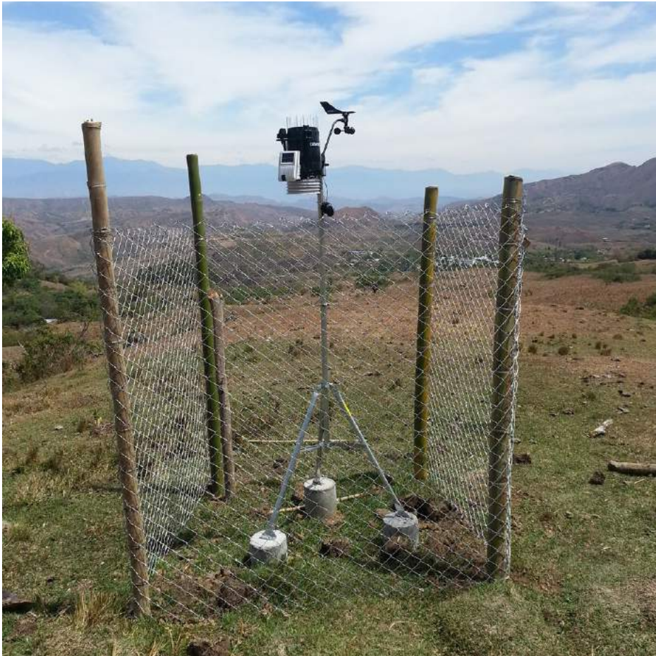
Figura 15. Estación meteorológica para el registro de variables climáticas.
