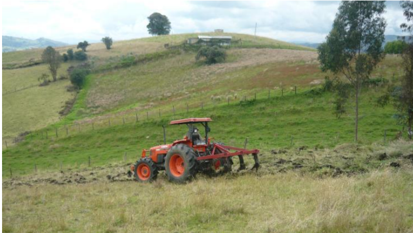
Figura 9. Preparación de suelo con arado de cincel Fuente: Pedro David Porras Rodríguez
