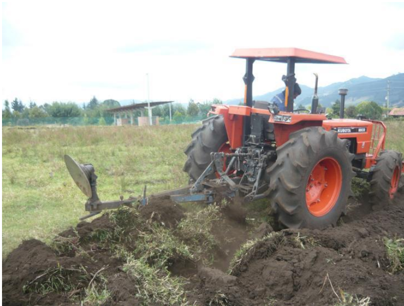
Figura 10. Preparación de suelo con arado de disco Fuente: Pedro David Porras Rodríguez
